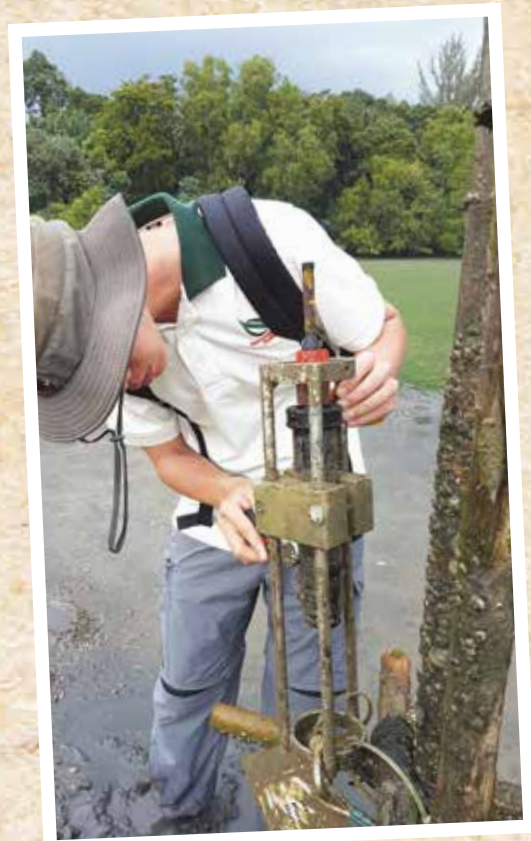
Mengumpul data pasang surut dari tolok pasang surut Foto oleh: Germaine Leng
